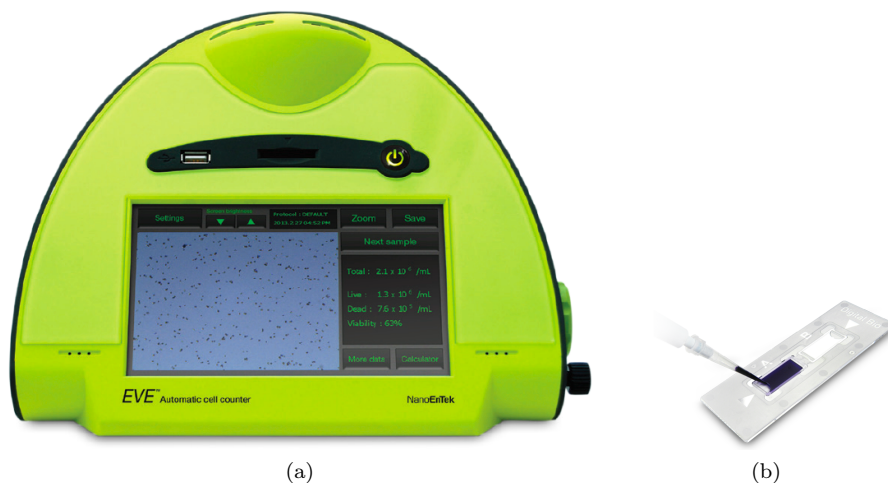
Rysunek 1: a) automatyczny licznik komórkowy EVE, b) płytka do zliczania komórek.
