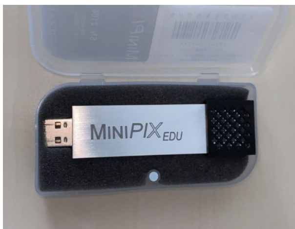
Rysunek 4: Detektor pikselowy typu Timepix, zintegrowany z urządzeniem MiniPIX EDU.
